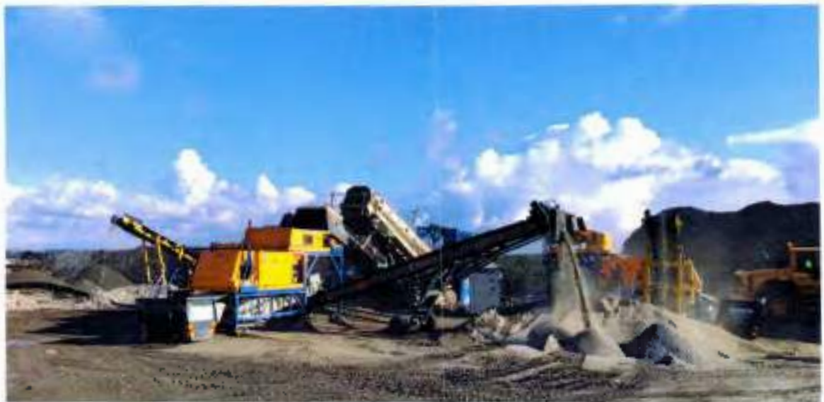
12 Pav. UAB „Fortum Heat Lietuva“ dugno pelenų (šlako) bandomasis apdorojimas Klaipėdos regioniniame sąvartyne.
