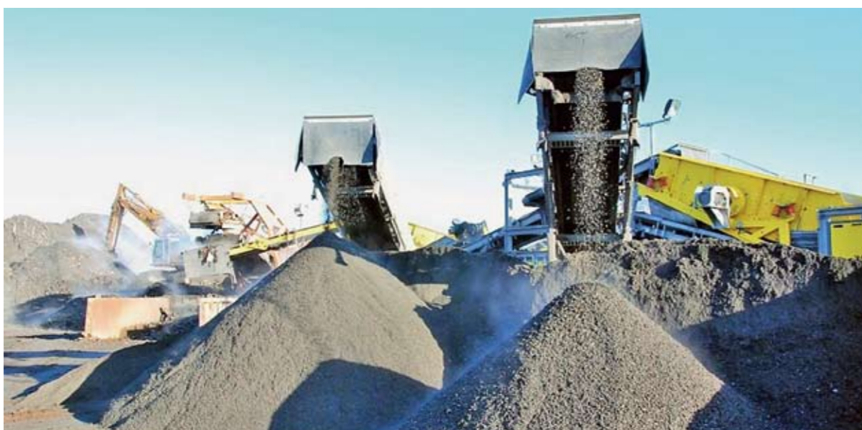
Sudegintų atliekų šlakas sąvartyne perdirbamas į statyboms tinkamas medžiagas.
